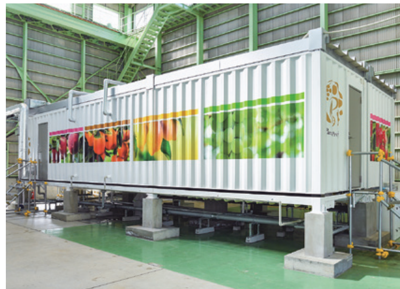
現在稼働中の同社のピューレ製造プラントはコンテナ内に設えてある(左)。コンテナには果物などの装飾も施した。コンテナの天井には、「ひかり屋根」を組み込み太陽光を緩やかに取り入れられる造りになっている(上)
